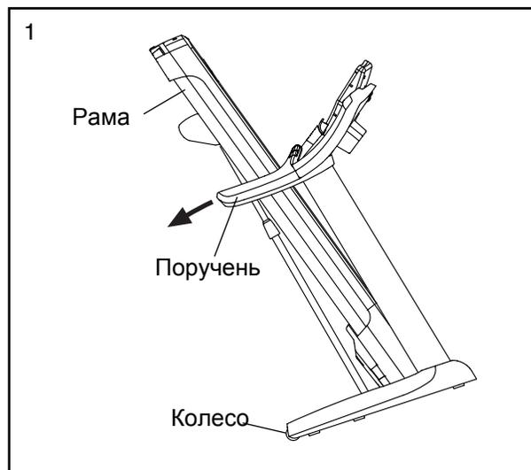
2. Потяните беговую дорожку в противоположную от поручней сторону и катите её на колесах, таким образом перемещая её в нужное место. **ВНИМАНИЕ:** не двигайте беговую дорожку, не наклоняя её назад, не тяните за каркас, и не передвигайте беговую дорожку по неровной поверхности.
