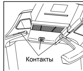
Для измерения вашей частоты сердцебиения **встаньте на боковое ограждение** и удерживайте металлические пластины пульсометра ладонями, **не двигая руками**. Когда ваш пульс будет измерен, значение появится на экране. **Для наиболее точного определения частоты пульса, держитесь за контакты около 15 секунд.**
