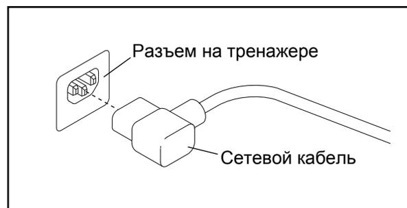
2. Воткните вилку сетевого шнура в подходящую розетку, установленную и заземлённую в соответствии с местными законами и предписаниями.
