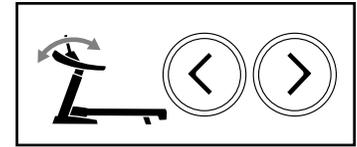
Вы можете сохранить до четырех настроек наклона консоли для разных пользователей. Чтобы сохранить текущую настройку консоли наклона, сначала нажмите кнопку "Memory", а затем сразу нажмите одну из цифровых кнопок пользователей.
