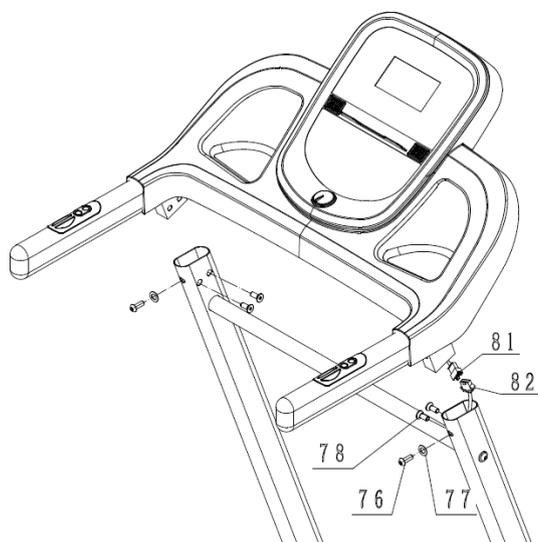
Вначале соедините кабель консоли (81) с кабелем стойки консоли (82). Закрепите консоль на стойках консоли болтами М8\*25 (76), шайбами Ф8 (77) и болтами М8\*15 (78).
