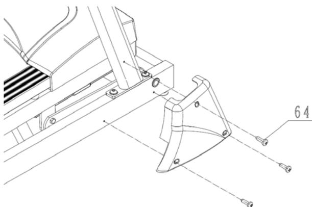
Установите защитный кожух стойки консоли на стойку консоли и закрепите его винтами ST4.2\*15 (64).
