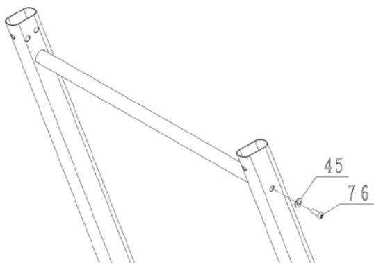
Закрепите поперечину на стойках консоли шайбами ф8 (45) и болтами М8\*25 (76).
