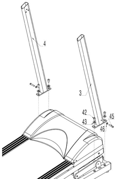
Соедините контрольный кабель стойки консоли и выходной кабель двигателя. Затем закрепите правую и левую стойки консоли на несущей раме при помощи болта M8\*40 мм. (45), болта M10\*20 (42) и шайб: Ф10 (43) и Ф8 (46).
