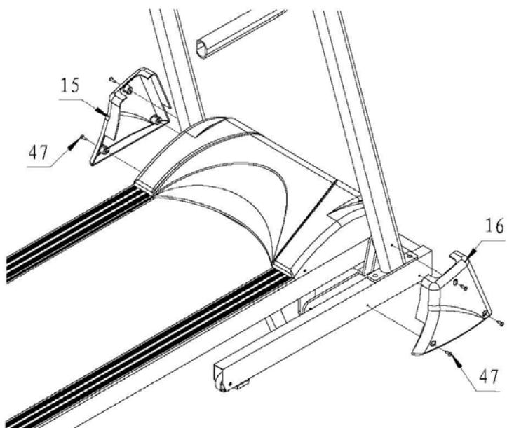
Закрепите кожухи на стойках, используя винты ST4.2\*15 (47).
