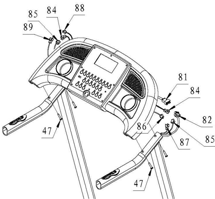
1. Подсоедините друг к другу провода и зафиксируйте консоль на стойках, используя винты ST4.2\*15 (47).
