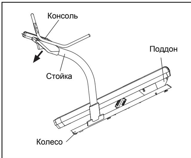
Аккуратно передвиньте тренажер на колеса в нужное место, а затем опустите его. **ВНИМАНИЕ:** чтобы снизить риск получения травм, проявите крайнюю осторожность при передвижении тренажера. Не пытайтесь передвигать тренажер по неровной поверхности.
