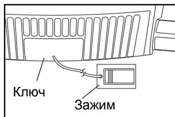
**ВАЖНО:** В экстренной ситуации ключ можно выдернуть из консоли, тогда беговое полотно плавно остановится. Проверьте зажим, осторожно сделав несколько шагов назад; если ключ не выдвигается из консоли, отрегулируйте положение зажима.
