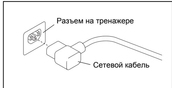
2. Вставьте вилку сетевого шнура в подходящую розетку, установленную и заземлённую в соответствии с местными законами и предписаниями.
